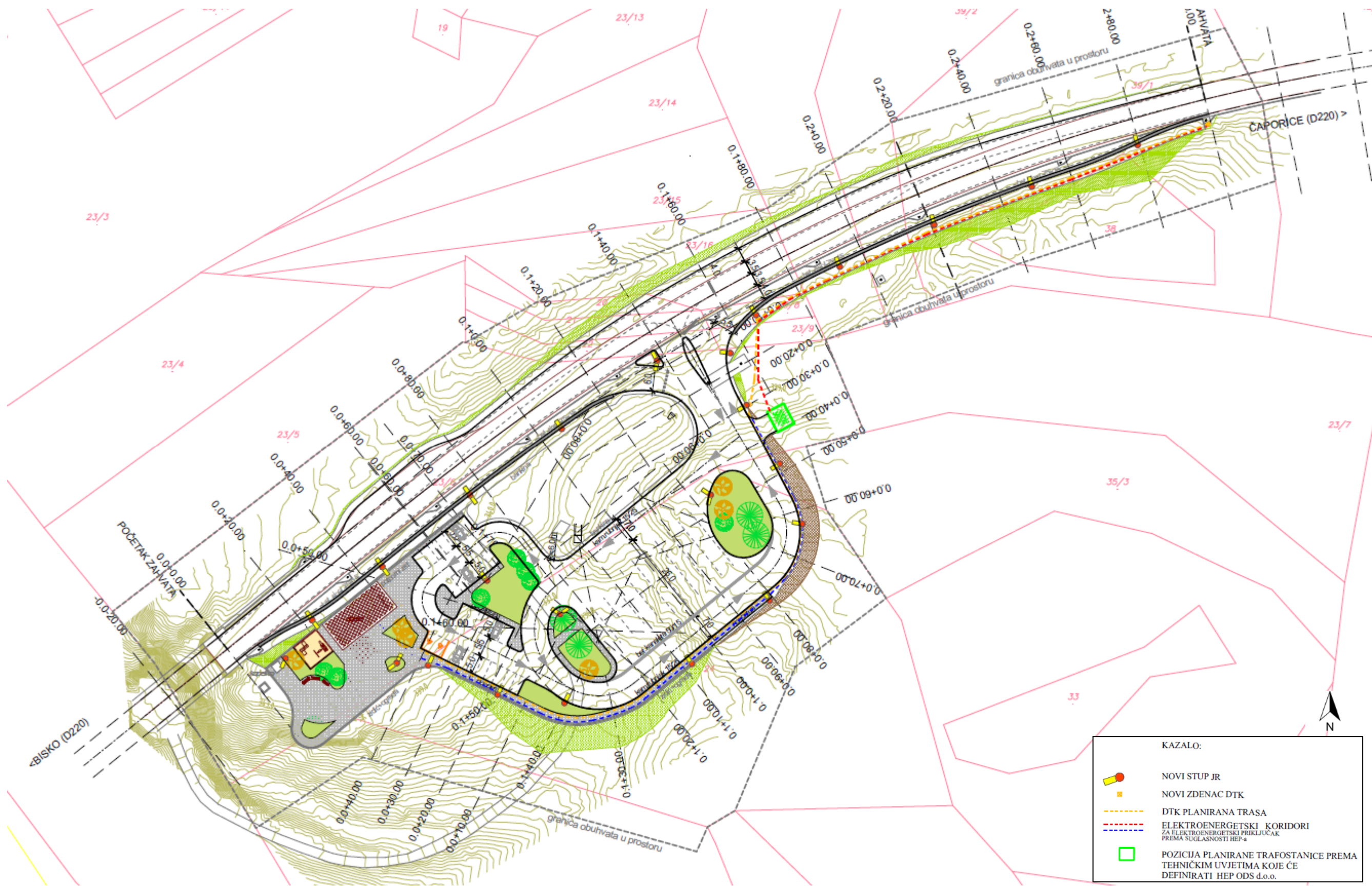
Slika 5. Situacija elektroenergetske mreže, javne rasvjete i distributivne telekomunikacijske kanalizacije (izvor: Idejni projekt Odmorište "Most sv. Mihovila" na državnoj cesti DC220; 1199-P2-06-02-1; Geoprojekt d.o.o., lipanj 2018.)
